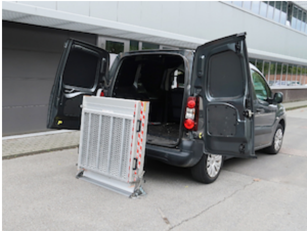
Pikalukitus rampin rungossa mahdollistaa rampin nopean kiinnityksen / irrotuksen, jolloin ajoneuvon käytettävyys on mahdollisimman joustavaa
